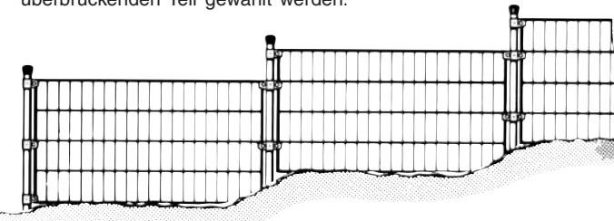
Bei den Mattenhöhen 500 mm und 750 mm benötigen Sie 2 Schellen pro Zaunpfahl; ab einer Mattenhöhe von 1000 mm werden 3 Schellen pro Zaunpfahl benötigt.
